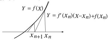
第 n 近似値  $x_n$  から第 n+1 近似値  $x_{n+1}$  を,点  $(x_n,f(x_n))$  における曲線 Y=f(X) への接線  $Y-f(x_n)=f'(x_n)(X-x_n)$  が x 軸と交わる点として定める: Y=0 と置いて
